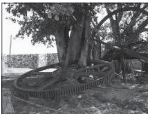
Restos del piñón y rueda catalina de la máquina de moler del que fue ingenio "La Demajagua"
